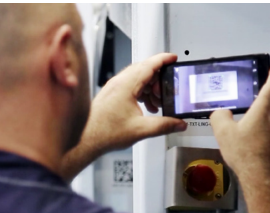
Der Maschinist verwendet die Movilizer App, um in SAP PM ein Ticket zu erstellen, das den Techniker sofort benachrichtigt.
